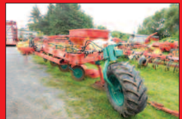
Charrue à versoirs Kverneland BE 115, 4 versoirs, haut dégagement, variable de 12 à 20 pouces, grosse roue, pneu 420R24XM108, très bon état.
