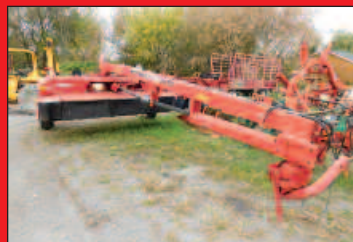
Faucheuse conditionneuse Case IH DCX 131, 13 pieds de coupe, conditionneur à rouleau, tête girodine, en très bon état.
