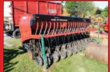
Semoir Case IH 5400, 15 pieds, minimum till, avec roue press wheel, coffre à mil et cart avant.
