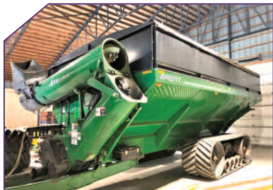
Grain cart Brent Avalanche 2000, sur chenille, balance, chargement de plus de 50 tonnes, comme neuf.
